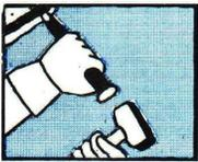
a) a) La grieta o fisura donde se aplicará el AQUAPLUG deberá ampliarse, en corte cuadrado, por lo menos a 2 cm de ancho por 2 cm de profundidad. Limpie suciedad y falsas adherencias.
