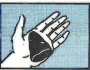
c) c) Evite movimiento durante 30 a 60 segundos presionando el tapón para facilitar el fraguado del AQUAPLUG contra la presión del agua.
